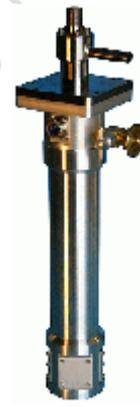
LT4 液氦/液氮连续流型低温恒温器
