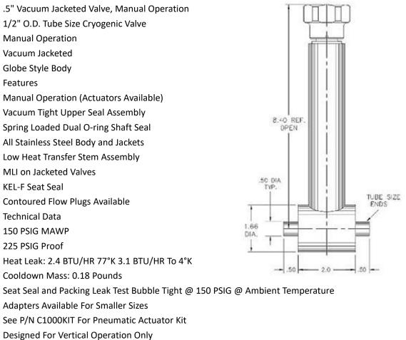
Replaces Cryolab<sup>®</sup> CV9 Valve Series
