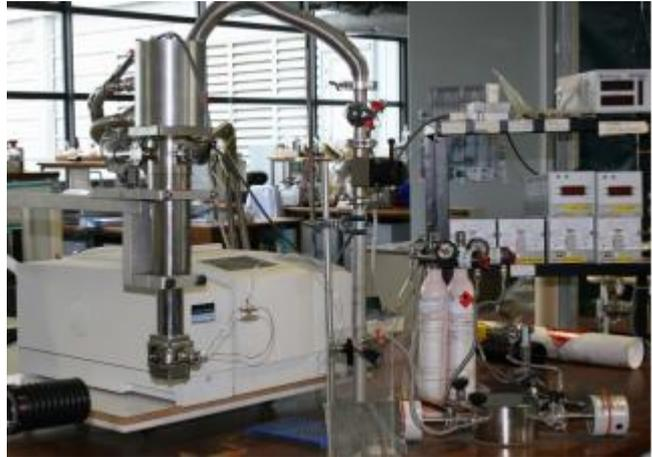
上图为基质隔离系统。右下角为混合室。膨胀器和样品可以手动相对真空罩和窗口进行旋转。样品旋转过程中，真空罩不动。
