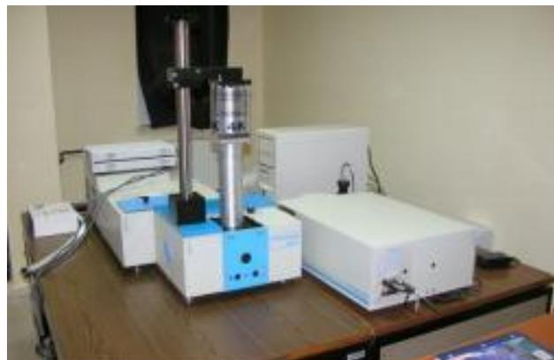
图示为安装在 Jobyn Yvon 光谱仪上的闭循环低温系统
