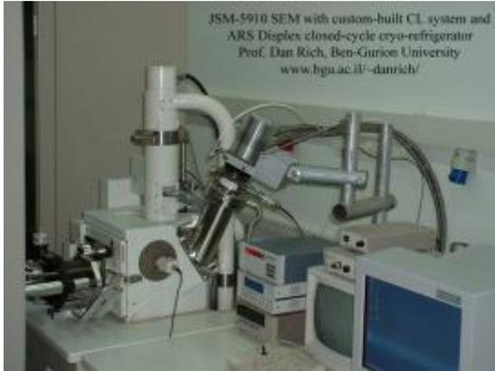
上图展示了 Displex 和它的界面。照片中所有不锈钢的部分都是对我们的 JSM-5910 扫描电镜的升级。请注意我的网站上发表的论文，其中演示了用这个低温系统获得的 CL 的结果。
