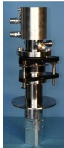
超低振动系统用于 BOMEM, DA8 FTIR 分光仪。
